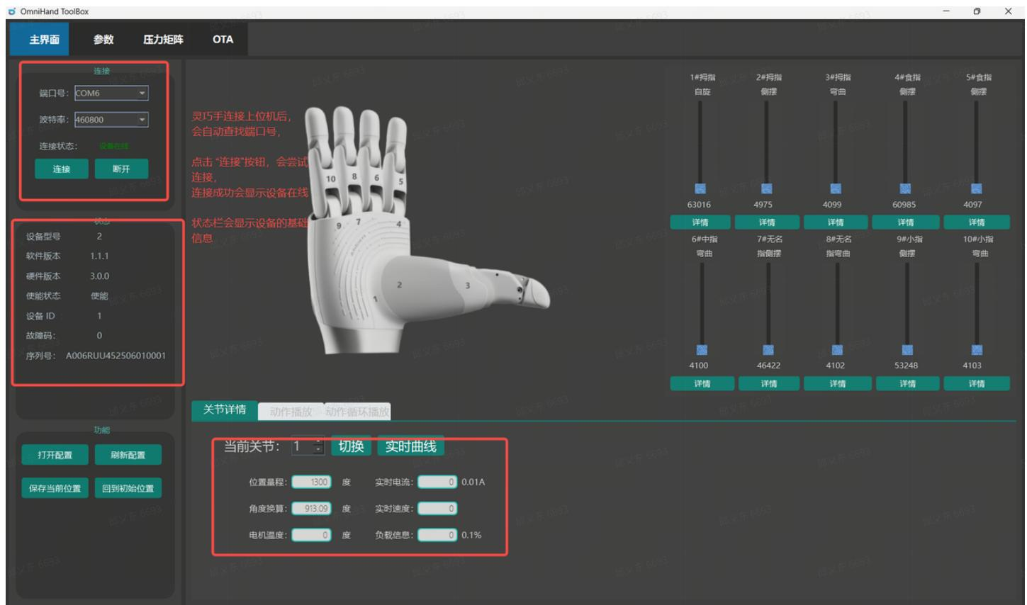
若显示“设备在线”，但是**无法操作灵巧手的运动**，请检查“端口号”中是否有其他端口，请重新选择端口号后进行连接。
