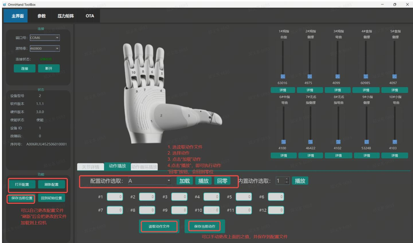
在本上位机中，可以自定义各种动作，并将当前设置好的动作姿态保存到配置文件中，以便在下次要执行动作的时候，可以一键操作。回零按钮可以让所有
