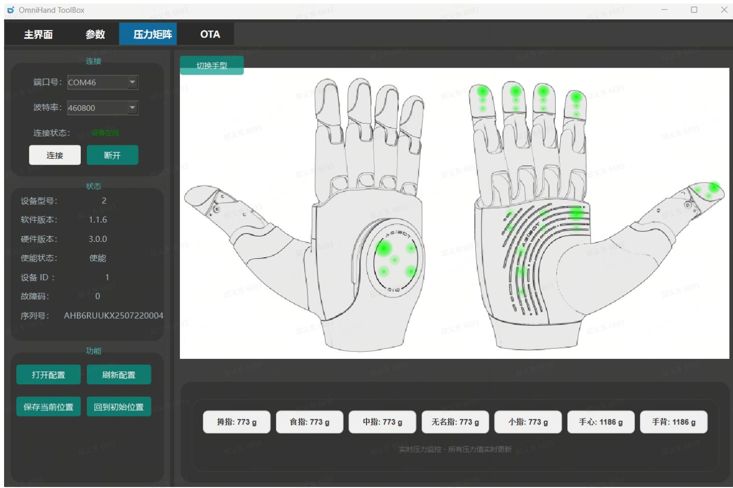
点击“压力图标”按钮，可以查看五个手指指尖、手心和手背的压力情况，其中在每个手指的指尖的压力测点合成了3个点，手心9个压力测点，手背5个压力测点
