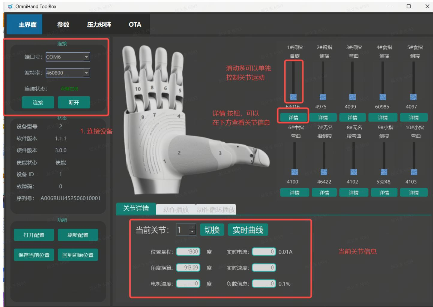
当上位机软件与灵巧手成功建立连接后，在主界面中可对灵巧手进行操作控制。
